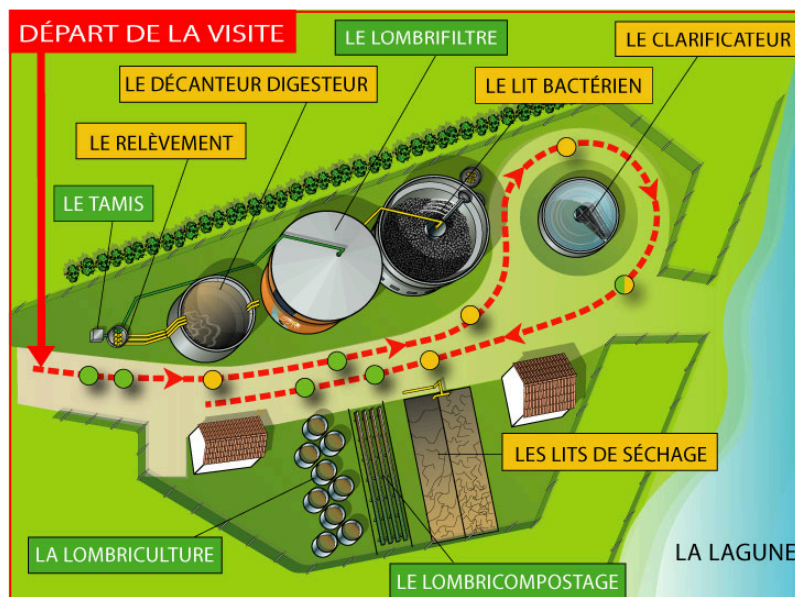
Schéma de la STEP de Combaillaux
